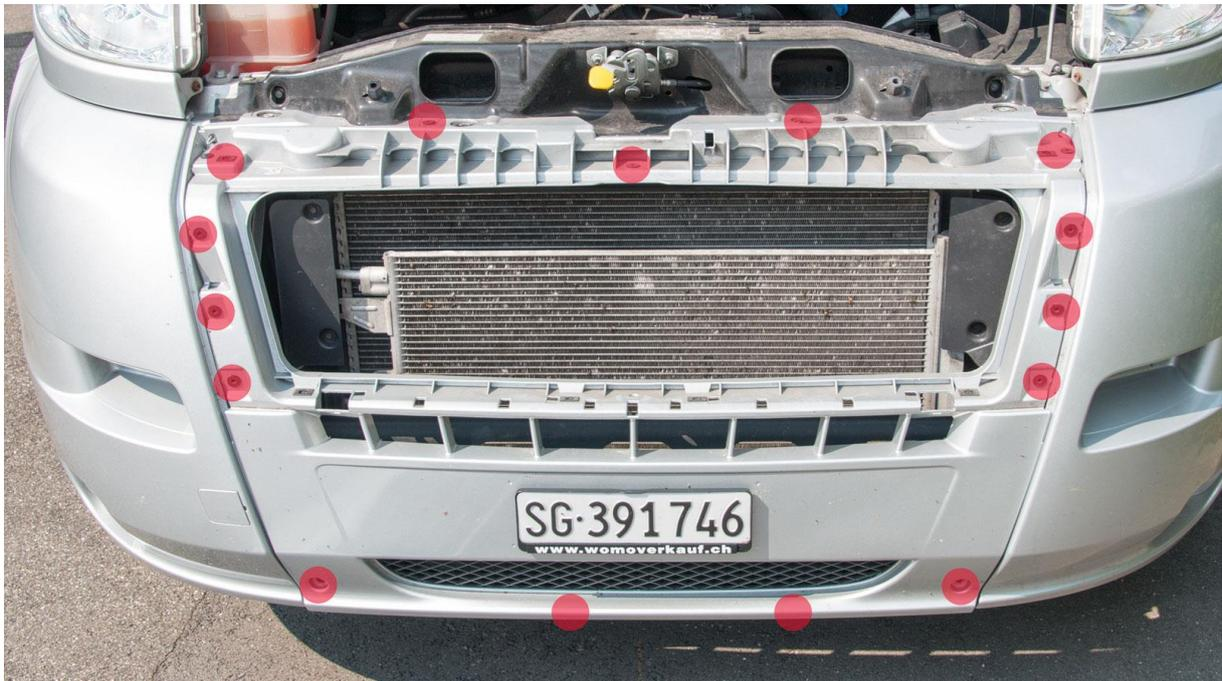
Sind die Schrauben gelöst oben links und rechts mit der Hand unter die Abdeckung fassen und die Abdeckung hochdrücken, bis sich die Plastikeinraster innen lösen. Danach kann die gesamte Partie nach oben weggezogen werden.
