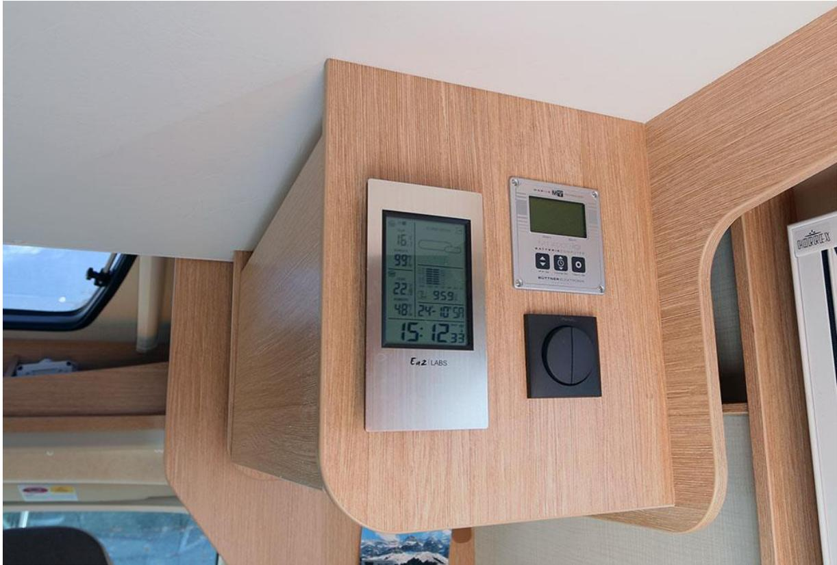
Aber Achtung, zuerst das Steuerungskabel in den Batteriecomputer einstecken, die Anzeige ins Loch fügen und mit vier Schrauben anziehen. Fertig.
