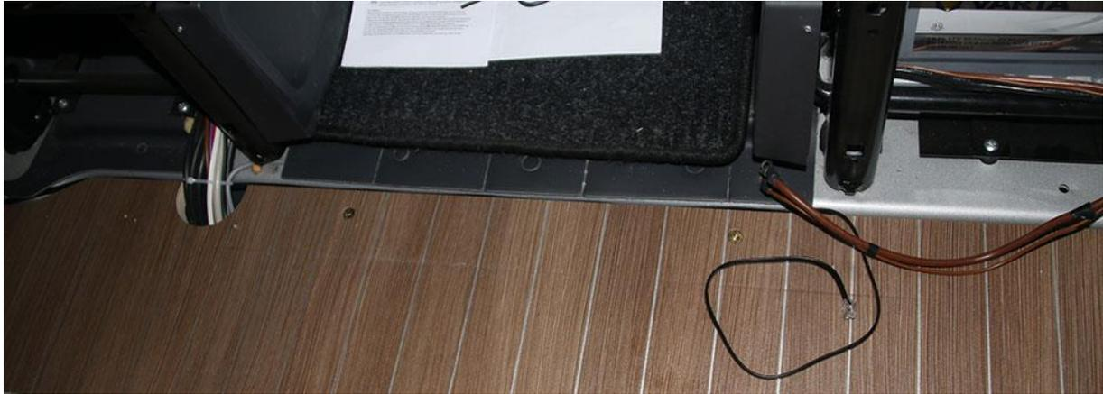
Weil das bis jetzt so problemlos ging, zog ich gerade auch noch ein zweipoliges, dünnes Kabel durch mein gebohrtes Loch in der Seitenkonsole bis unten. So habe ich schon mal ein Kabel dort unten, das ich später vielleicht für den Aussentemperaturfühler brauchen kann. Dieses Kabel reicht schlussendlich von der Anzeige bis unten bei der Fahrertüre in der Verkleidung. So ist dieses Kabel bereit, wenn ich den Aussentemperaturfühler montieren will und einen Durchgang nach Aussen gefunden habe.
