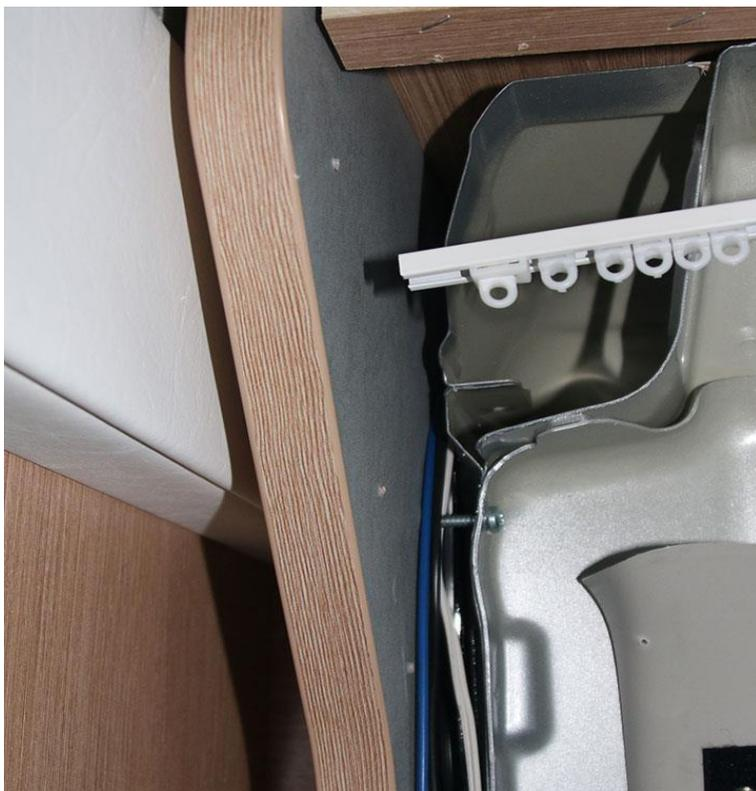
Dann hat es schön Platz, das Steuerkabel in diesem Schlitz bis zum Boden zu ziehen. Im Boden kann es durch den Spalt zwischen Fahrerhaus und Wohnbereich durchgeschoben werden und so bis zum Batterieblock auf der Beifahrerseite verlegt werde.
